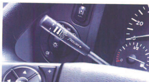
Ovládací páčky hydrostatu Easy Drive vlevo pod volantem pro nastavení směru jízdy vpřed / vzad a tempomatu
